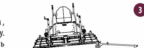
**ШАГ 4.** Закрепите колесную опору на раме затирочной машины с помощью штифтов.
