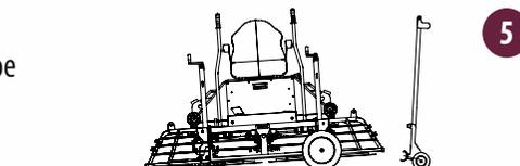
**ШАГ 6.** Разместите транспортировочную тележку с левой стороны от двухроторной затирочной машины и подведите под раму.
