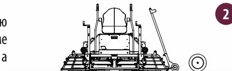
**ШАГ 3.** Тележкой, как рычагом, приподнимите затирочную машину за раму. Зафиксируйте рукоять (лучше работать вдвоем, чтобы избежать подъема телеги и падения «вертолета»).
