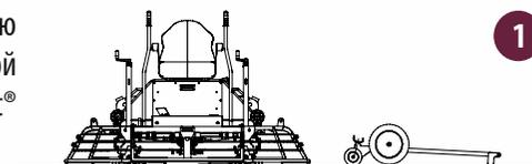
**ШАГ 2.** Вынув штифты, отсоедините колесную опору от тележки и подведите зацепом к раме затирочной машины, как показано на рисунке.
